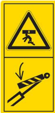
Travaux sur la machine, autorisés uniquement lorsque le dispositif de sécurité des cylindres est en place
