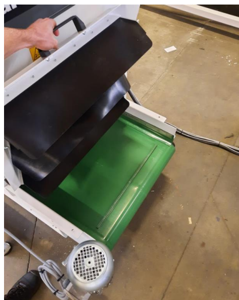
Figure 10. Bande de décharge
