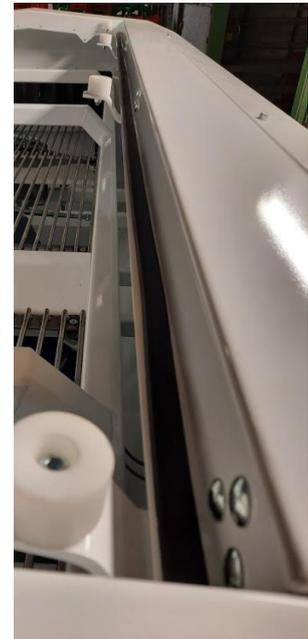
Abb. 17 Dichtung Dachabdeckung
