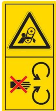
Bei laufender Maschine Schutzabdeckung nicht entfernen.
