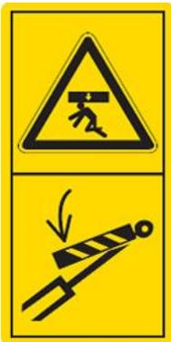
Arbeiten an der Maschine nur bei abgesichertem Zylinder.
