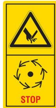
Erst nach vollständigem Stillstand der Maschine Bauteile anfassen.
