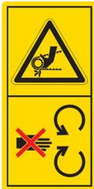
Bei laufender Maschine Schutzabdeckung nicht öffnen.
